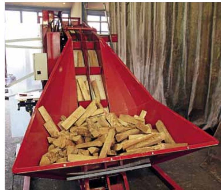
↑ Pilkkeet nousevat syöttösuppilosta kaksilokeroisella kolakuljettimella ylös ladontakammion päälle.
