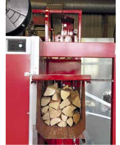
↑ Kone muokkaa nipusta pyöreäkulmaisen ja tiiviin. Muovivannenuha varmistaa, että nippu pysyy koossa.
