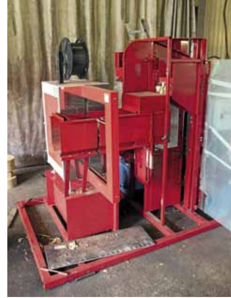
↑ Sidontalaitte on modifioitu automaattisesta vannesidontalaitteesta. Koneen perään on suunnitteilla liikkuva taso trukkilavoille, näin valmiiden pakkausten nostelu jää pois.
