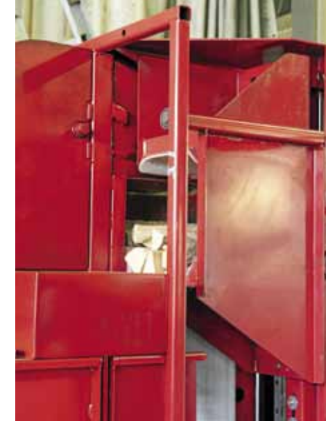
↑ Kolakuljettimen ladontakammioon nostamat pilkkeet työnnetään sivusuunnassa ladontatasolle. Tämän jälkeen valkoinen tiivistyslevy puristaa nipun tiiviimmäksi.
